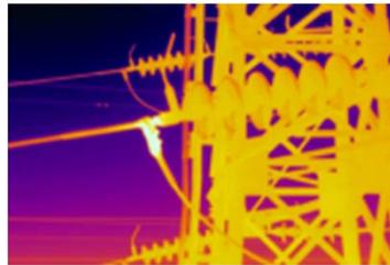
赤外線カメラにより電線等の発熱を確認し、設備異常の早期発見につなげます。
