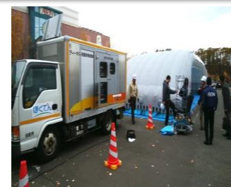
発電機車による電力供給
