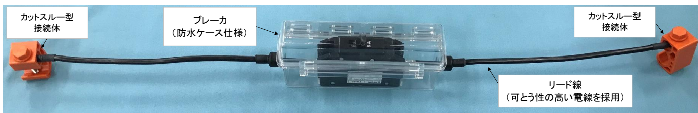
図3 仮送電用ブレーカ付バイパスケーブル
