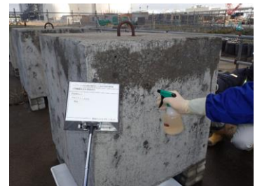
写真1 含浸材試験実施状況
