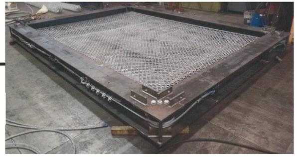
重要機器や配管を最大風速100m/sの竜巻から守る飛来物防護設備を設置
