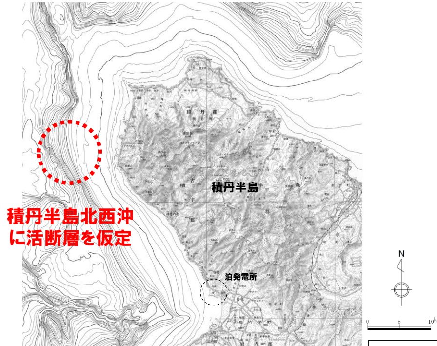
活断層の仮定位置
