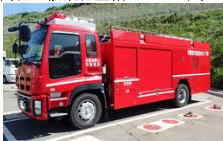
可搬型大型送水ポンプ車
