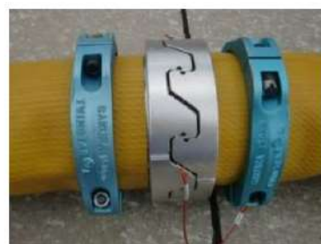
可搬型ホース(150A)接続後
