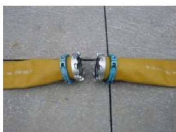
可搬型ホース (150 A) 接続前
