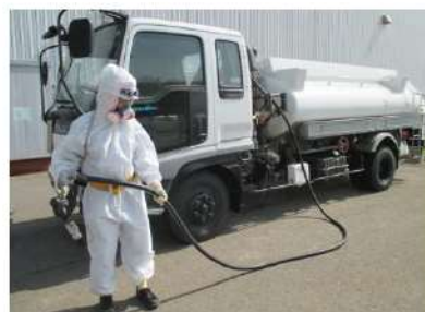
可搬型タンクローリー給油ホース引出し （屋外）
