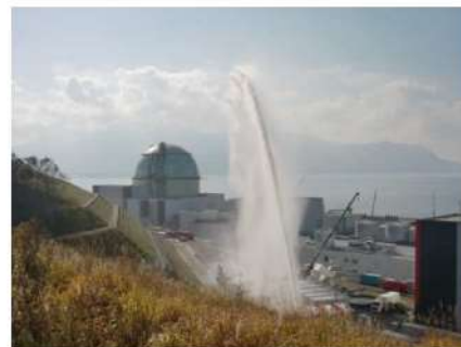
第10図 直状放射による放水状況
