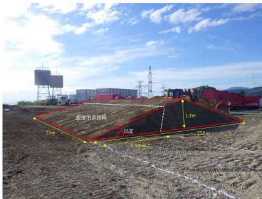
第3図 斜面崩壊後を模擬した土砂
