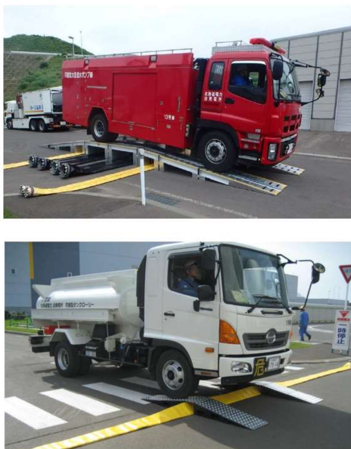
第1図 ホースブリッジの設置状況
