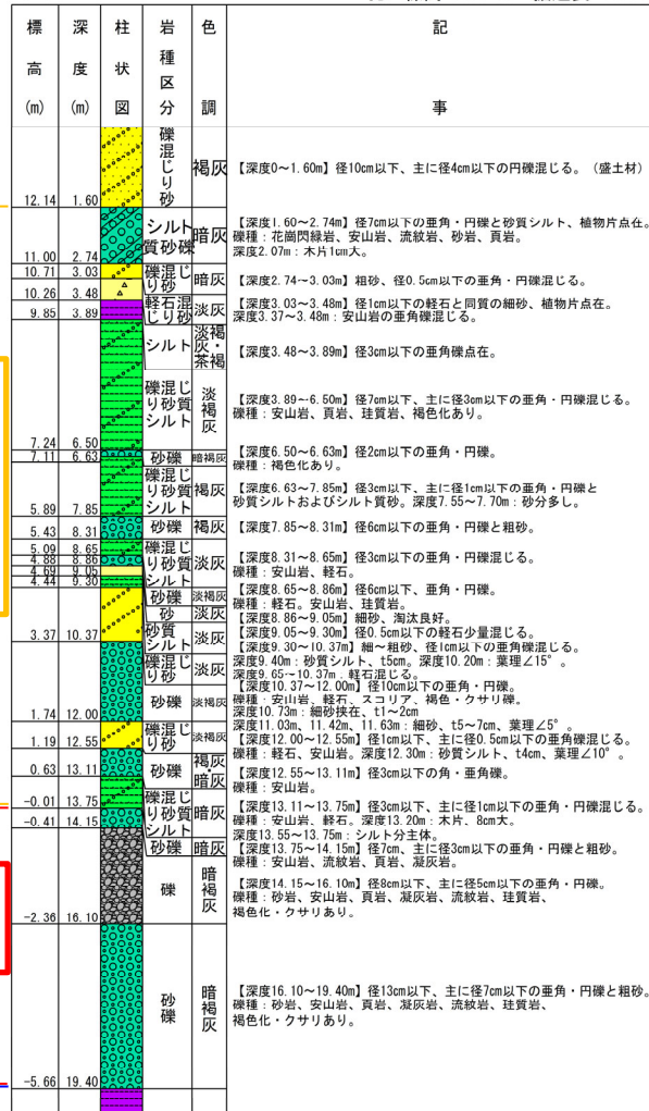
ボーリング柱状図（深度0～20m）
