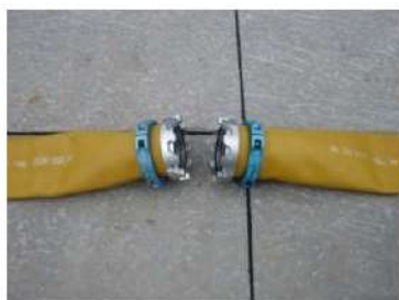
可搬型ホース(150A)接続前
