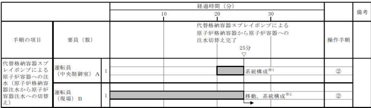
第 1.4.7 図 代替格納容器スプレイポンプによる原子炉容器への注水 (原子炉格納容器注水から原子炉容器への注水切替え) タイムチャート
