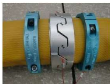
可搬型ホース（150A）接続後
