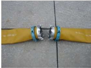
可搬型ホース（150A）接続前
