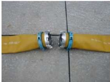
可搬型ホース（150A）接続前
