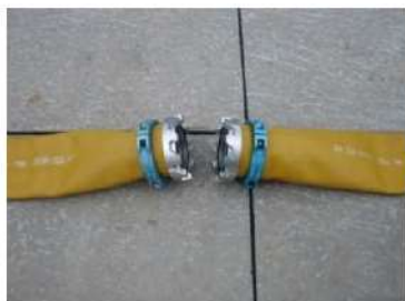
可搬型ホース(150A)接続前
