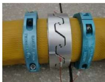
可搬型ホース(150A)接続後
