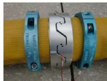
可搬型ホース（150A）接続後
