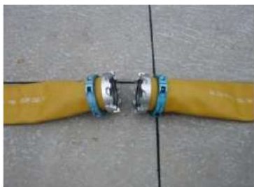
可搬型ホース(150A)接続前
