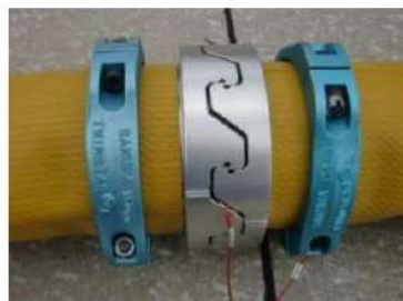
可搬型ホース(150A)接続後
