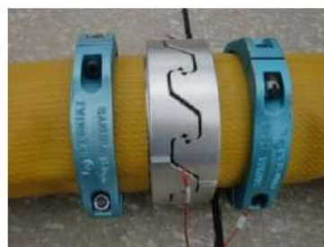
可搬型ホース(150A)接続後
