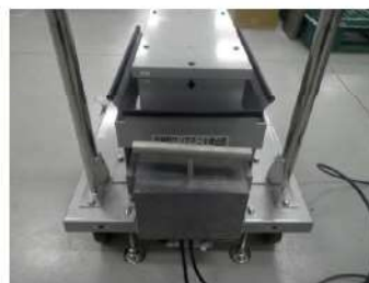
可搬型エリアモニタ 検出器側
