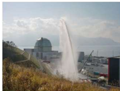
第10図 直状放射による放水状況
