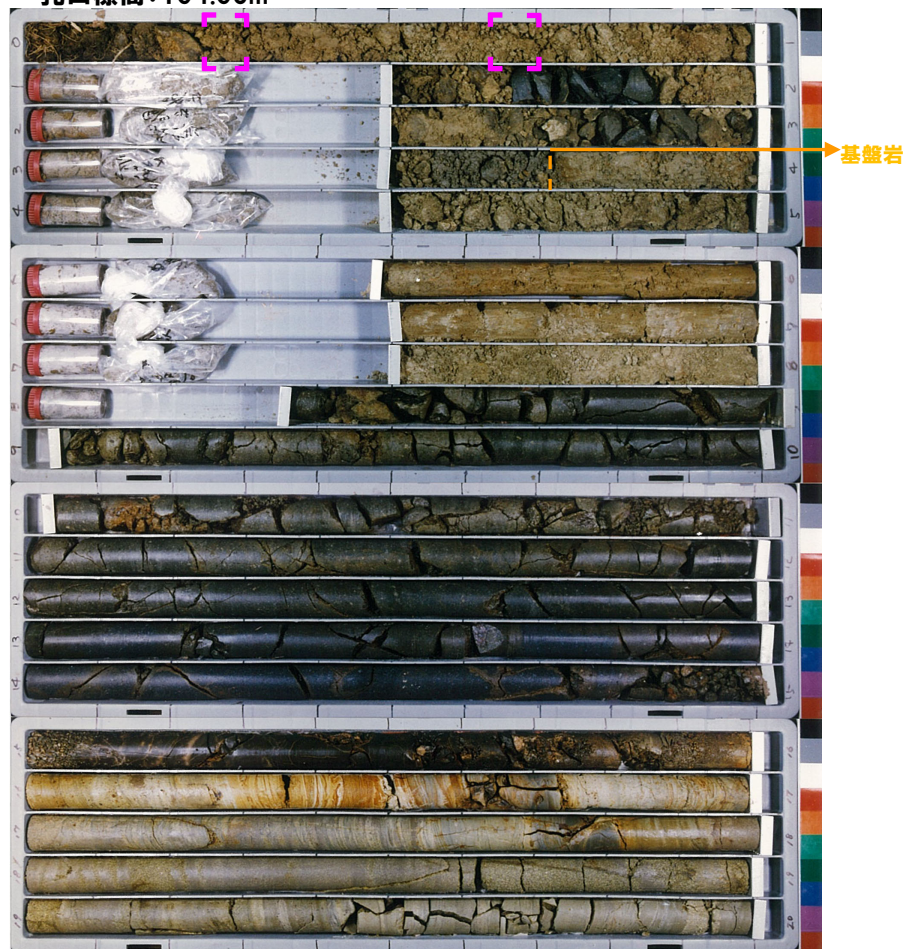
コア写真 (3B-4:深度0~20m) [ ] :火山灰分析試料採取箇所 (R3.10.14審査会合以降)
