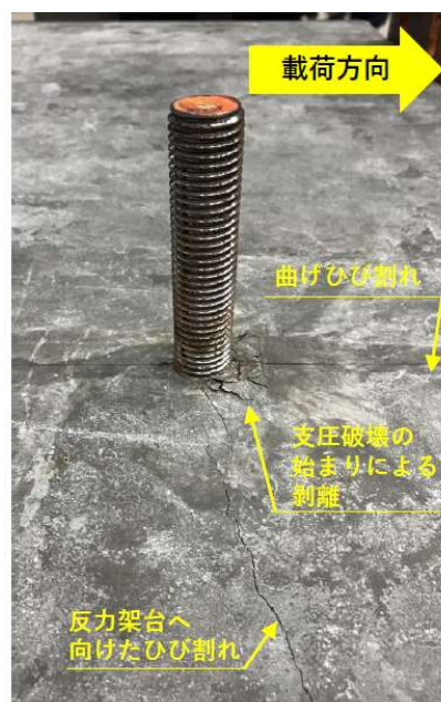
第 7-69 図 せん断試験後の状況写真（せん断 3）
