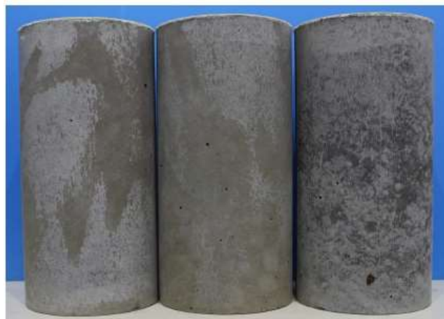
第 7-51 図 セメント改良土の室内試験用供試体 ( \phi 150\text{mm} , H300\text{mm} )
