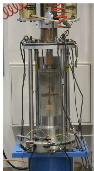
一軸圧縮試験の状況
