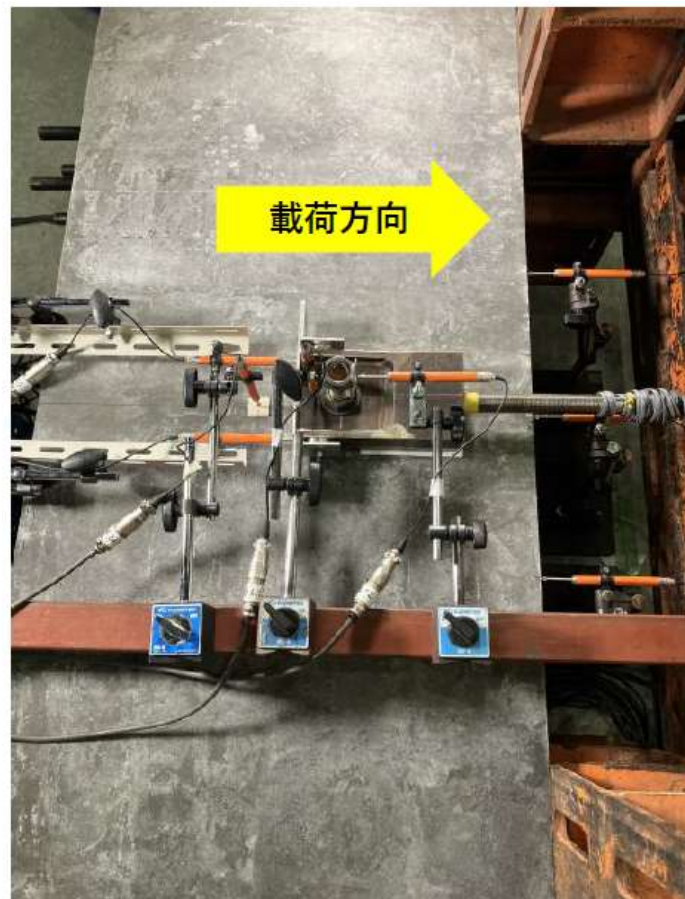
第 7-68 図 せん断試験最大荷重載荷後の状況写真（せん断 3）
