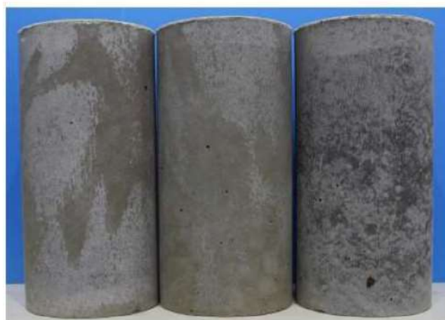
第 7-56 図 セメント改良土の室内試験用供試体 ( \phi 150\text{mm} , H300\text{mm} )
