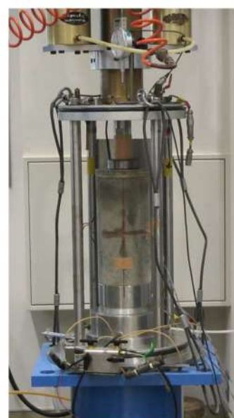
一軸圧縮試験の状況
