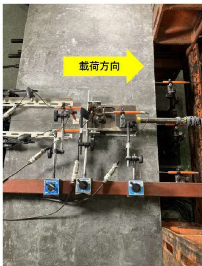
第 7-73 図 せん断試験最大荷重載荷後の状況写真（せん断 3）
