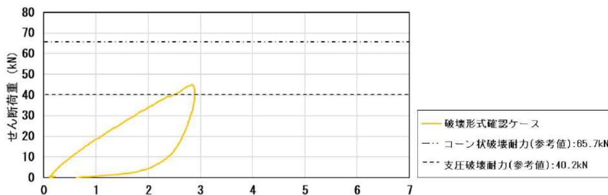
第 7-75 図 アンカーボルトの水平変位 破壊形式確認ケース (mm)
