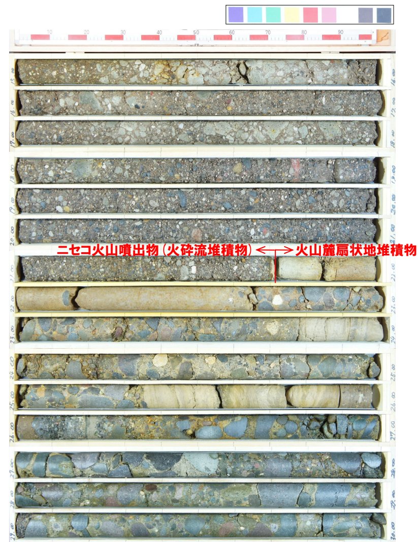
H29岩内-1コア写真(深度15~30m, 標高17.22~2.22m)
