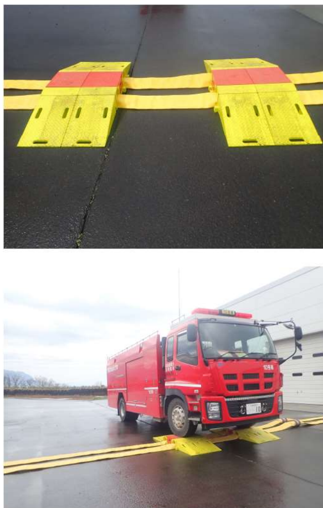
第1図 ホースブリッジの設置状況
