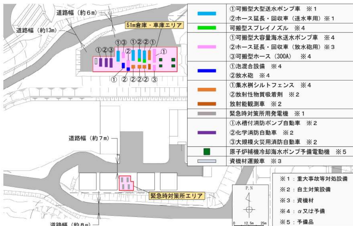
第 2 図 保管場所の可搬型設備配置 (1/3)
