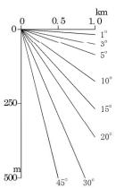
数字(角度)は水平・垂直が 1:1の傾斜角度 V.E. 約4
