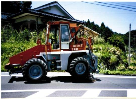
震源車(油圧インパクト) 全幅: 1.9m 全長: 4.8m
