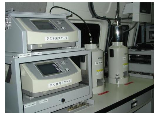
車載用ダスト・よう素測定装置
