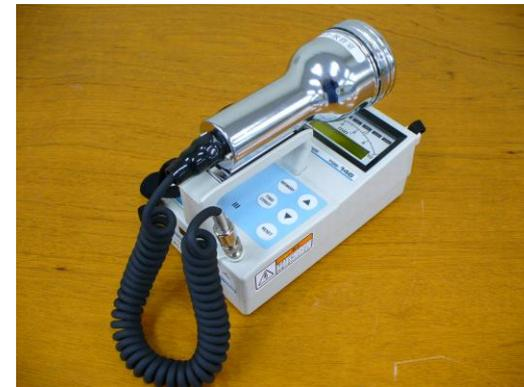
GM管式汚染サーベイメータ
