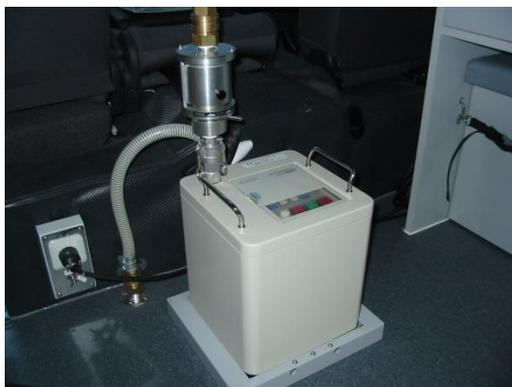
車載用ダスト・よう素サンプリング装置
