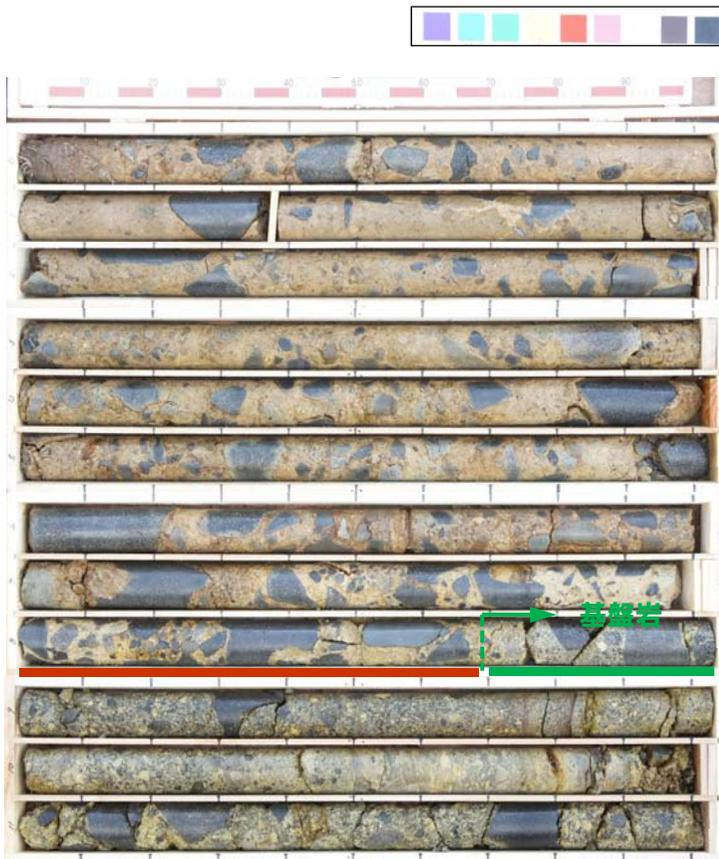
深度8.7m以深に基盤岩 (凝灰角礫岩) を確認した。
