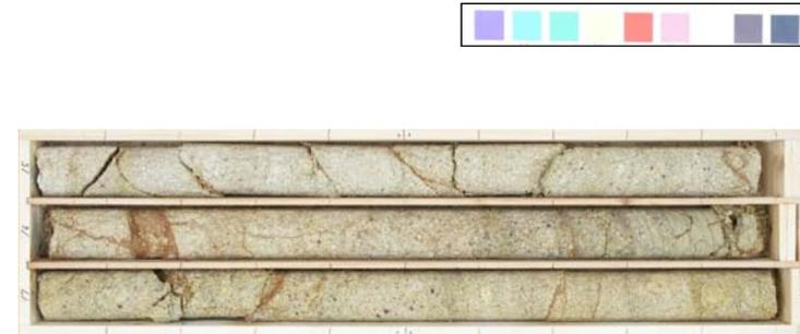
深度7.34m以深に基盤岩 (砂岩) を確認した。11.30mから火山礫凝灰岩が分布する。深度約5.1~7.1mに円礫が混じる砂礫層が分布するが、下位の基盤が破碎していることから、段丘堆積物としていない。砂岩は破碎されており、下位の火山礫凝灰岩の境界も破碎している、上位の堆積物は円~亜円礫主体の砂礫層である。
