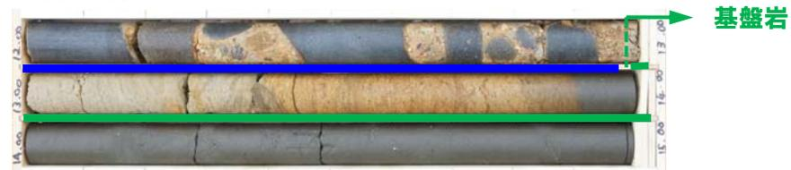
深度2.2~12.99mで段丘堆積物, 12.99m以深に基盤岩 (泥岩)を確認した。
