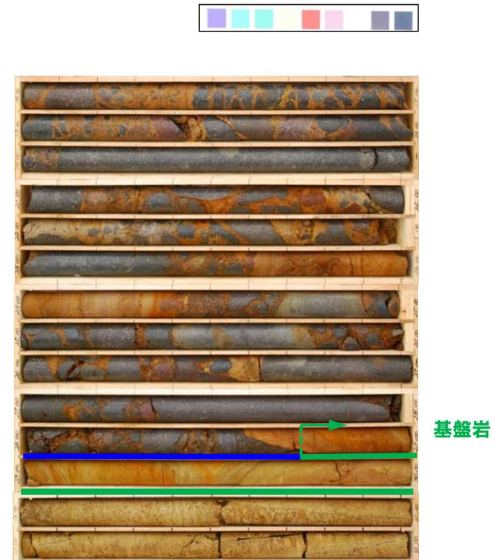
深度2.65～28.75mで段丘堆積物, 28.75m以深に基盤岩 (砂岩)を確認した。
