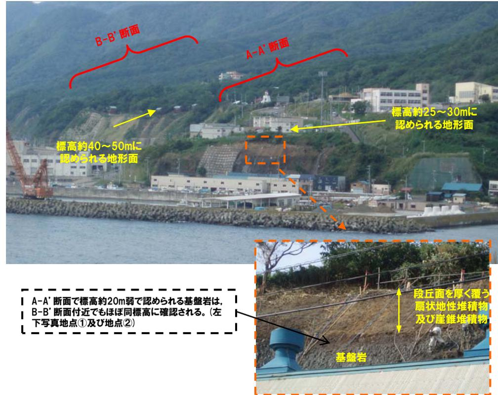
A-A'断面で標高約20m弱で認められる基盤岩は、B-B'断面付近でもほぼ同標高に確認される。(左下写真地点①及び地点②)
