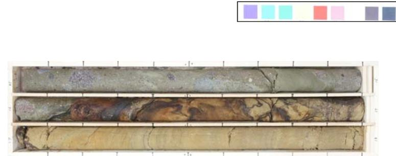
深度約7.65m以深に基盤岩(砂岩・礫岩)を確認した。
