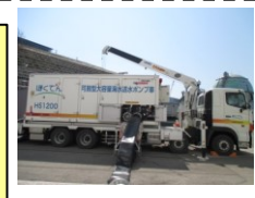
可搬型大容量海水送水ポンプ車
