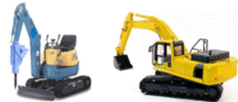
小型・大型無線重機 (屋外のガレキ等の除去)
