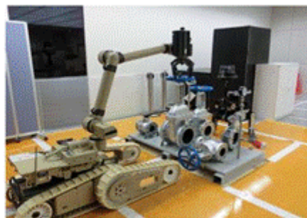
バルブの開閉操作
