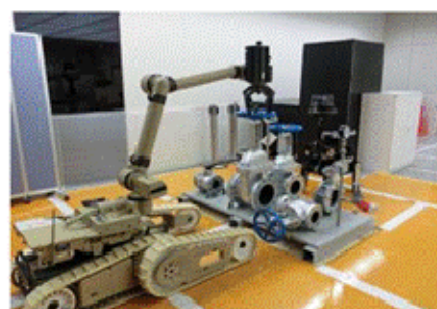
バルブの開閉操作
