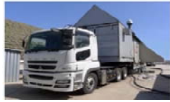
代替非常用発電機
