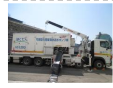
可搬型大容量海水送水ポンプ車
