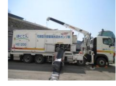
可搬型大容量海水送水ポンプ車
