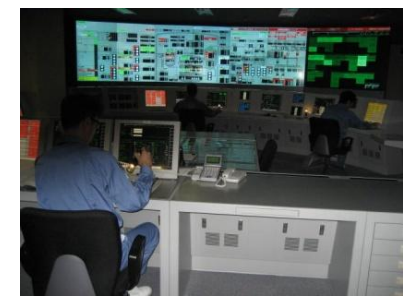
全交流動力電源喪失を想定した運転シミュレータ訓練
