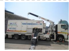
可搬型大容量海水送水ポンプ車
