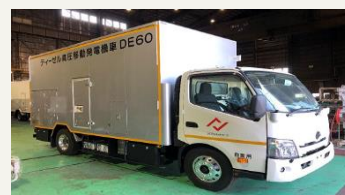
高圧移動発電機車
